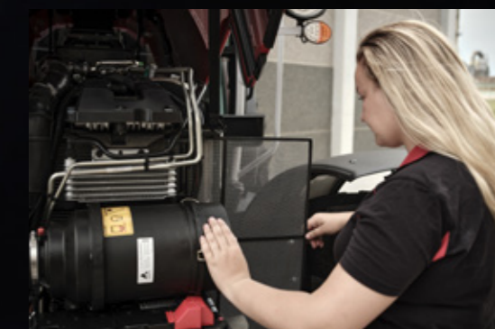
Le système de refroidissement est facilement accessible pour un nettoyage plus simple et rapide.
