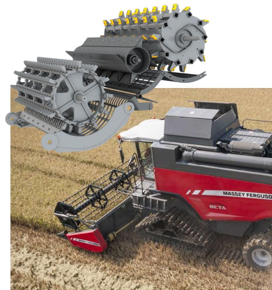
Une version de contre-batteur/batteur spécial riz est disponible avec des doigts uniques spécialement conçus pour la séparation dans des conditions difficiles. D'autres composants sont également renforcés pour une meilleure résistance à l'usure, comme les vis sans fin, les élévateurs ainsi que les dents du MCS. Ces caractéristiques associées à des chenilles autolubrifiantes et des tables de coupe robustes constituent une machine polyvalente, pour le riz, les céréales et le maïs.
