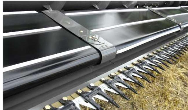
Le lamier se situe à 1,14 m de distance de la vis d'alimentation de la table de coupe afin d'offrir une visibilité et des performances optimales. Les robustes tapis PowerFlow transfèrent la récolte depuis le lamier jusqu'à la vis d'alimentation à vitesse constante, et se chargent également d'éjecter les pierres afin d'éviter tout endommagement de la machine.
