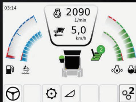
◀ L'écran d'Informations générales est constamment affiché dans le quartier supérieur gauche du terminal. Le régime moteur et la vitesse d'avancement sont affichés à côté des jauges de carburant, d'AdBlue, d'huile et de température moteur. Un graphique affiche également le statut en temps réel de la trémie et de la vis de vidange.
