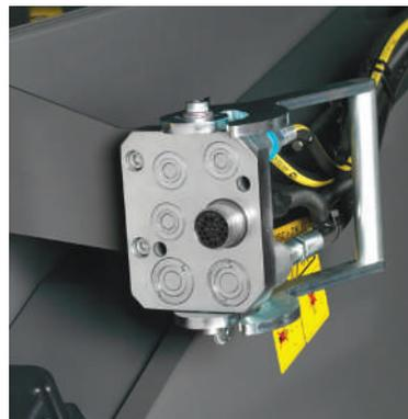
Multicoupleur combinant les branchements hydrauliques et électriques de série pour une dépose de table rapide.
