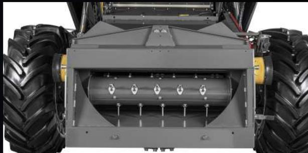
Le rouleau d'alimentation, situé à l'avant du convoyeur, offre un flux de récolte régulier, de la table de coupe jusque dans le convoyeur. Le système d'alimentation peut s'inverser en toute simplicité depuis la cabine.
