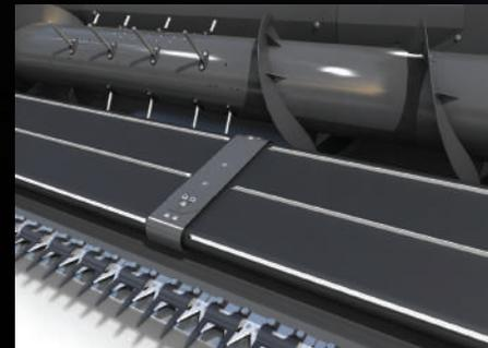
Le lamier se situe à 1,14 m de distance de la vis d'alimentation de la table de coupe afin d'offrir une visibilité et des performances optimales. Les robustes tapis PowerFlow transfèrent la récolte depuis le lamier jusqu'à la vis d'alimentation à vitesse constante, et se chargent également d'éjecter les pierres afin d'éviter tout endommagement de la machine.
