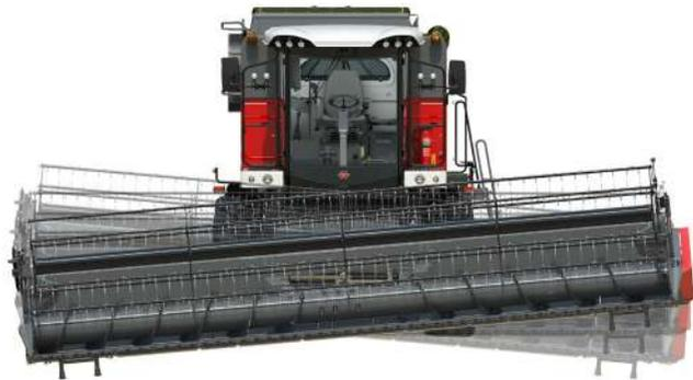
Le système AutoDevers contrôlant le suivi du relief du sol par la coupe est disponible en option. La transition fluide d'un côté à l'autre maintient une hauteur de coupe régulière et précise, grâce à l'action conjointe des performants circuits hydraulique et électronique.
