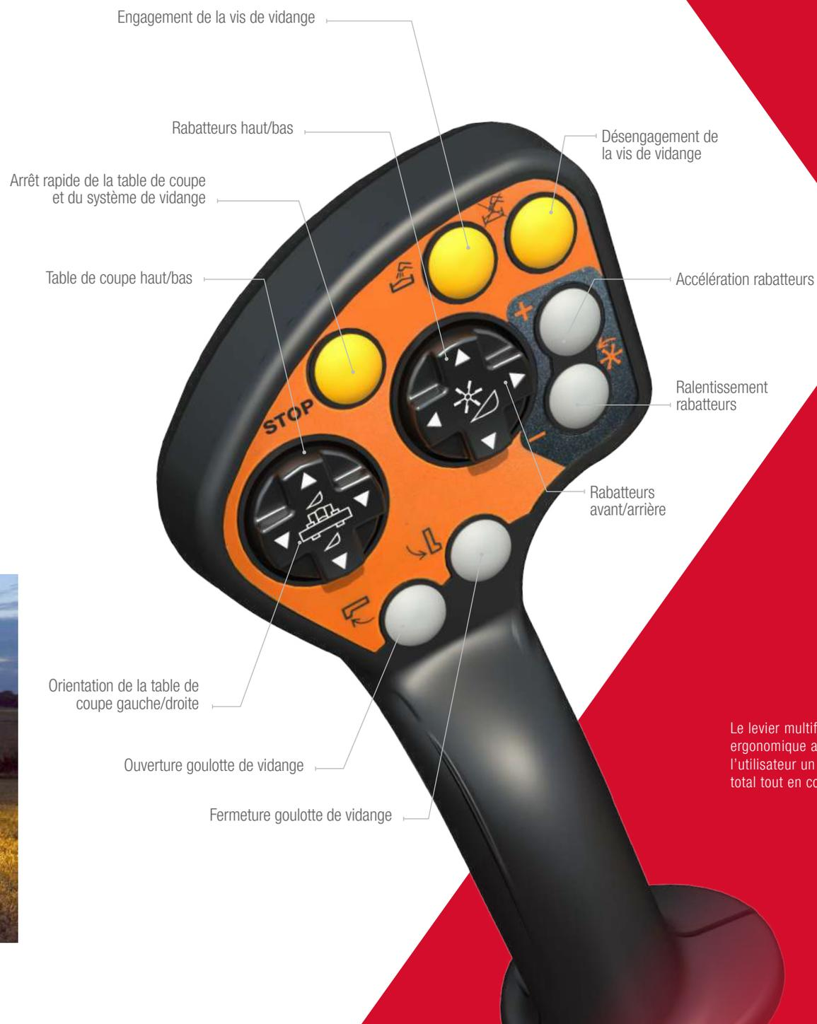
Le levier multifonction ergonomique apporte à l'utilisateur un contrôle total tout en confort.
