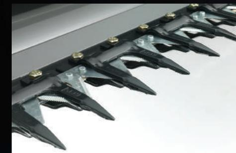
Avec 1 220 coups par minute, le lamier Schumacher est le plus performant du marché. Autonettoyant et constamment aiguisé, il se charge de la coupe de la récolte sans interruption et même dans les conditions les plus difficiles.
