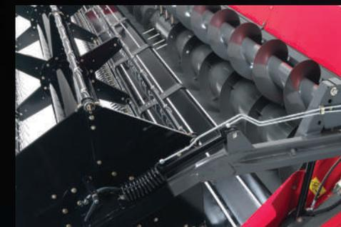
La vis pour colza disponible en option pour la table PowerFlow améliore le flux des récoltes hautes vers le convoyeur et augmente ainsi considérablement le débit de la machine. Deux scies latérales électriques viennent compléter le kit pour colza.
