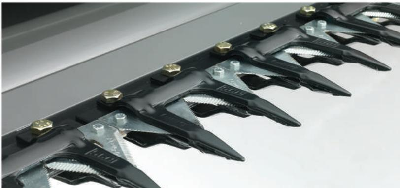
Avec 1 254 coups par minute, le lamier Schumacher est le plus performant du marché. Autonettoyant et constamment aiguisé, il se charge de la coupe de la récolte sans interruption et même dans les conditions les plus difficiles.
