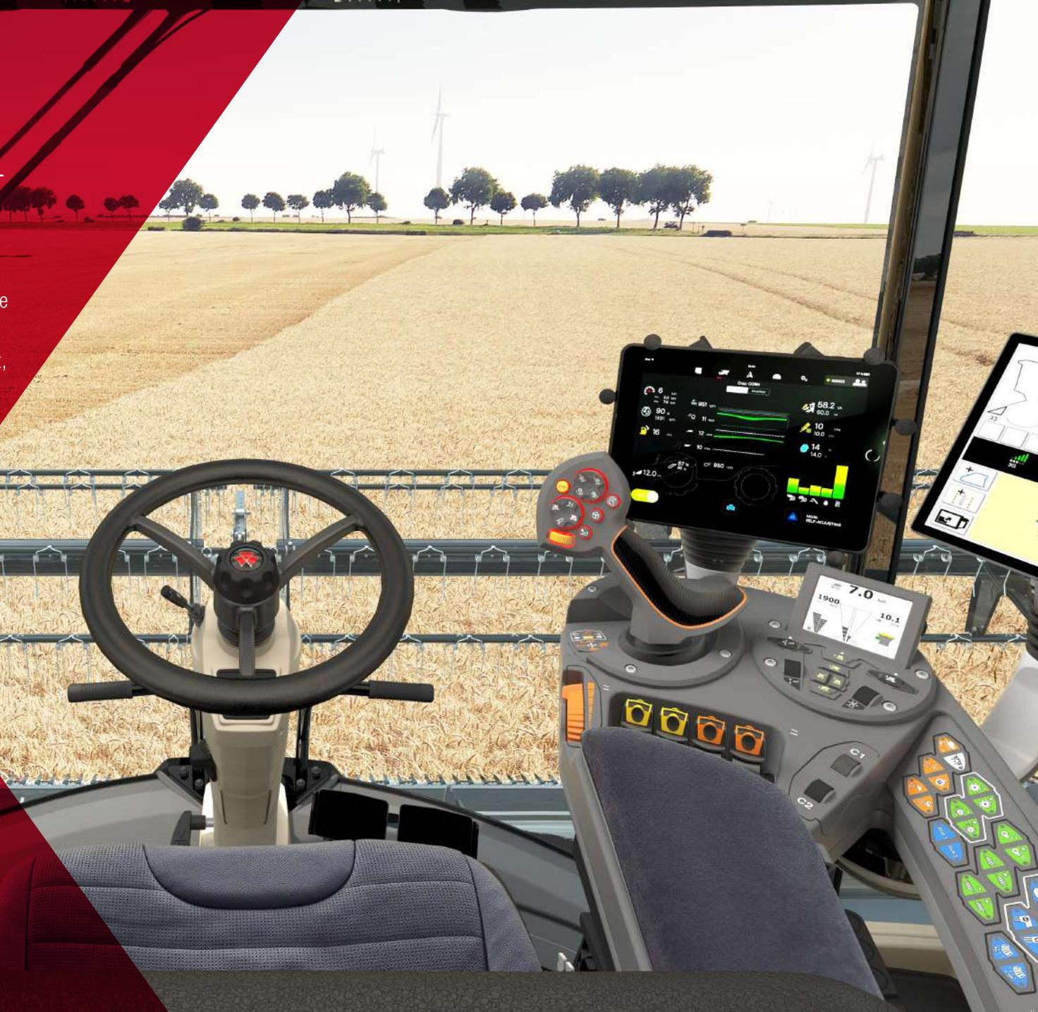
Le tableau de bord clair affiche en permanence les données de fonctionnement essentielles, par exemple les pertes de grain. La possibilité de faire pivoter le terminal principal TechTouch de 90° vers la droite de l'utilisateur permet d'améliorer la visibilité sur la table de coupe.
