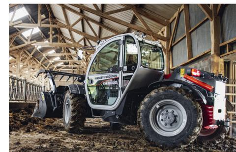
Deux positions de cabine pour une polyvalence optimale, avec notamment une position basse pour la manutention dans les bâtiments de faible hauteur. Grâce à leur design compact, ces modèles peuvent circuler dans des zones très étroites, sans perte de visibilité et de maniabilité.
