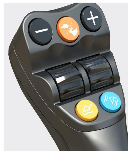
◀ **LA FONCTION DE SECOUAGE DU GODET** est une nouvelle option proposée avec la position flottante de la flèche sur le nouveau joystick. L'opérateur peut désormais vider facilement l'outil des matériaux collants en appuyant sur le commutateur bleu et en bougeant le joystick vers la droite en même temps.
