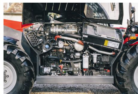
▲ Avec un capot renforcé et une plus grande ouverture, les modèles MF TH bénéficient également d'un nouveau système de poignée pour faciliter l'ouverture du capot et offrir un accès aisé pour l'entretien.
