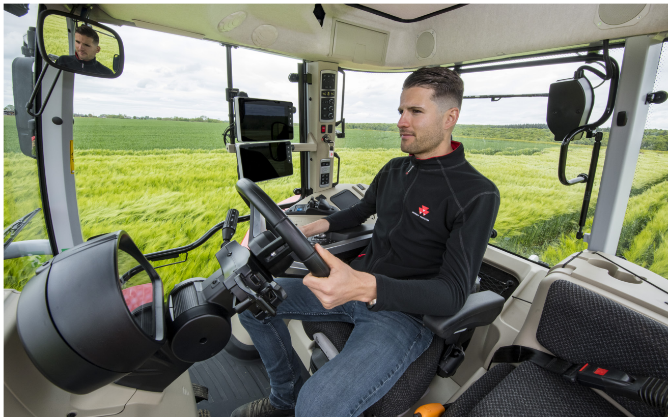
VERSION ESSENTIEL Siège pivotant à suspension pneumatique de série, avec appuie-tête, absorbeur de chocs longitudinal et réglage mécanique des lombaires.
