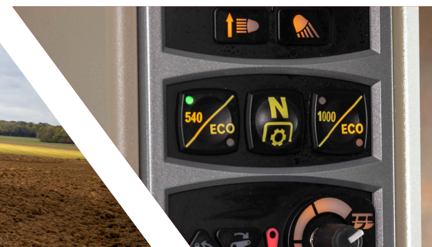
Sélection électro-hydraulique de la vitesse de la prise de force
