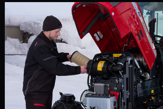
La conception du système de refroidissement garantit une facilité d'accès, de nettoyage et d'entretien. Le filtre à air moteur est également très facile d'accès pour le nettoyage.
